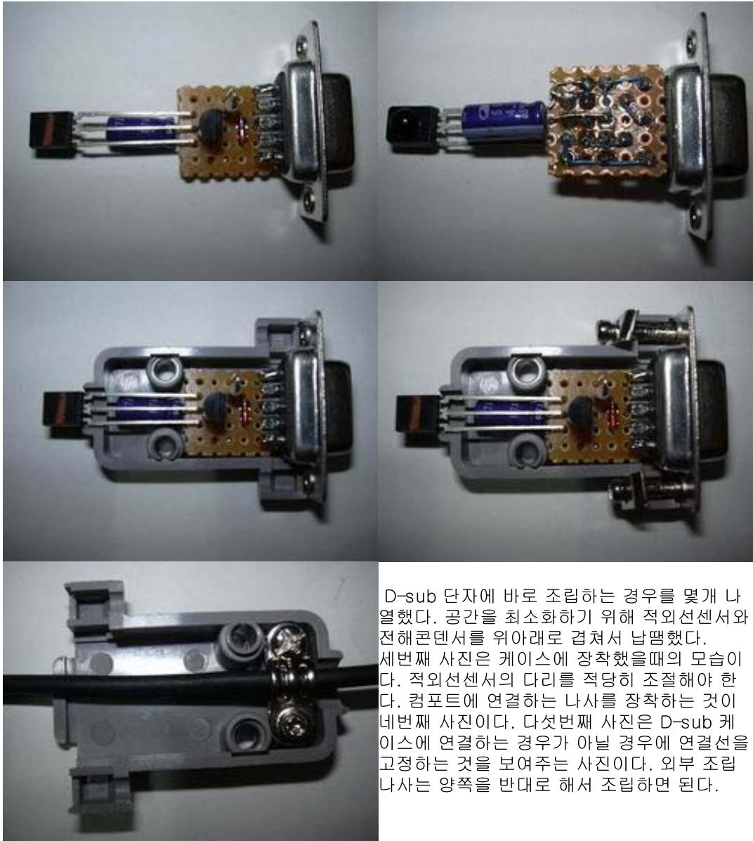
D-sub 단자에 바로 조립하는 경우를 몇개 나열했다. 공간을 최소화하기 위해 적외선센서와 전해콘덴서를 위아래로 겹쳐서 납땜했다. 세번째 사진은 케이스에 장착했을때의 모습이다. 적외선센서의 다리를 적당히 조절해야 한다. 커넥트에 연결하는 나사를 장착하는 것이 네번째 사진이다. 다섯번째 사진은 D-sub 케이스에 연결하는 경우가 아닐 경우에 연결선을 고정하는 것을 보여주는 사진이다. 외부 조립나사는 양쪽을 반대로 해서 조립하면 된다.
